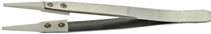
Value-Tec 2A.ZTA セラミック先端ピンセット 平坦、丸型 全長 128mm
